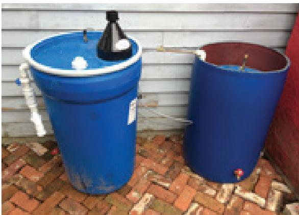
Gambar 3. Digester yang terhubung ke penampung biogas
